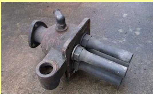
01/02/2014- Four cone ejector.
